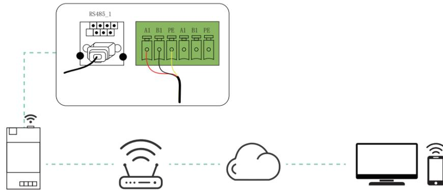
多台逆变器端子排连接方式
