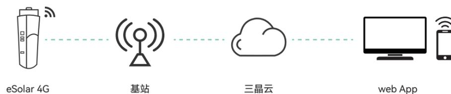
(4)多台逆变器连接时，可通过 eSolar SEC 模块联接 Internet，将逆变器数据上传到服务器，用户可以通过网页版 Web Portal 或者手机客户端远程监控逆变器运行信息。
