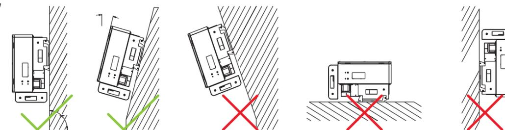
图 4.1 安装方式
