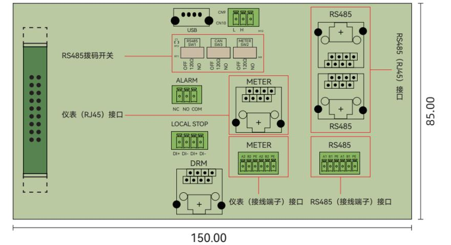
RS485 通讯端子和仪表通讯端子分有 RJ45 和接线端子两种接口形式且功能完全相同,接线时只需任选其中一种进行连接。
