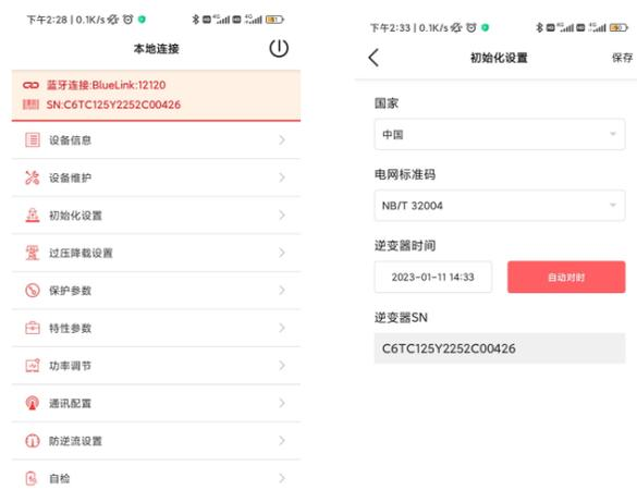
(2)单台逆变器通过 eSolar AI03 Pro 模块联接 Internet，将逆变器数据上传到服务器，用户可以通过网页版 Web Portal 或者手机客户端远程监控逆变器运行信息。
